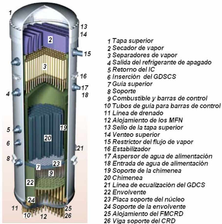
Figura 2-10 Corte de la vasija del ESBWR [6] y [8]
