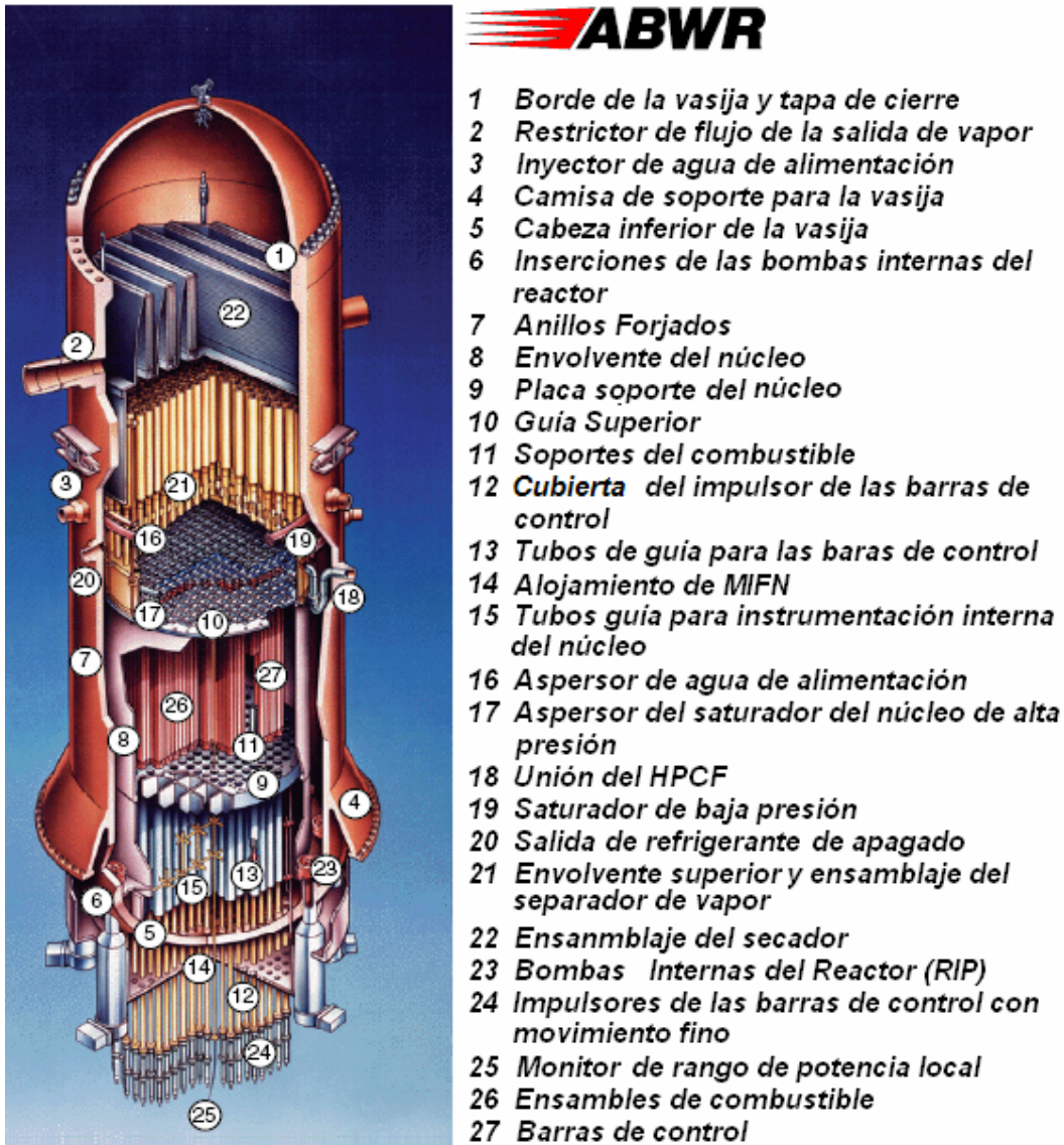
Fig. 2-6 Corte de la vasija ABWR y sus elementos principales [5]
