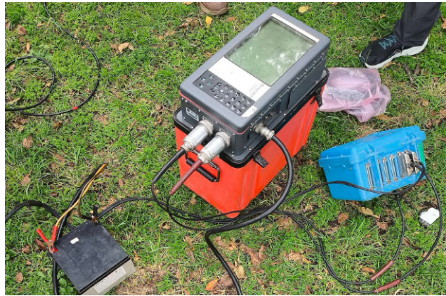
Figura 10: Sismógrafo Strataview empleado para la toma de datos.
