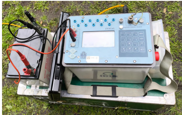
Figura 6: Resistivímetro Syscal Pro utilizado para la toma de datos en el área de estudio.
