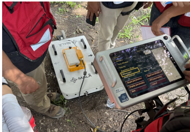
Figura 17: GPR y consola utilizados para la toma de datos en el área de estudio.
