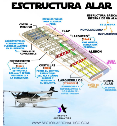
Figura 4: Componentes estructurales del ala [21]
