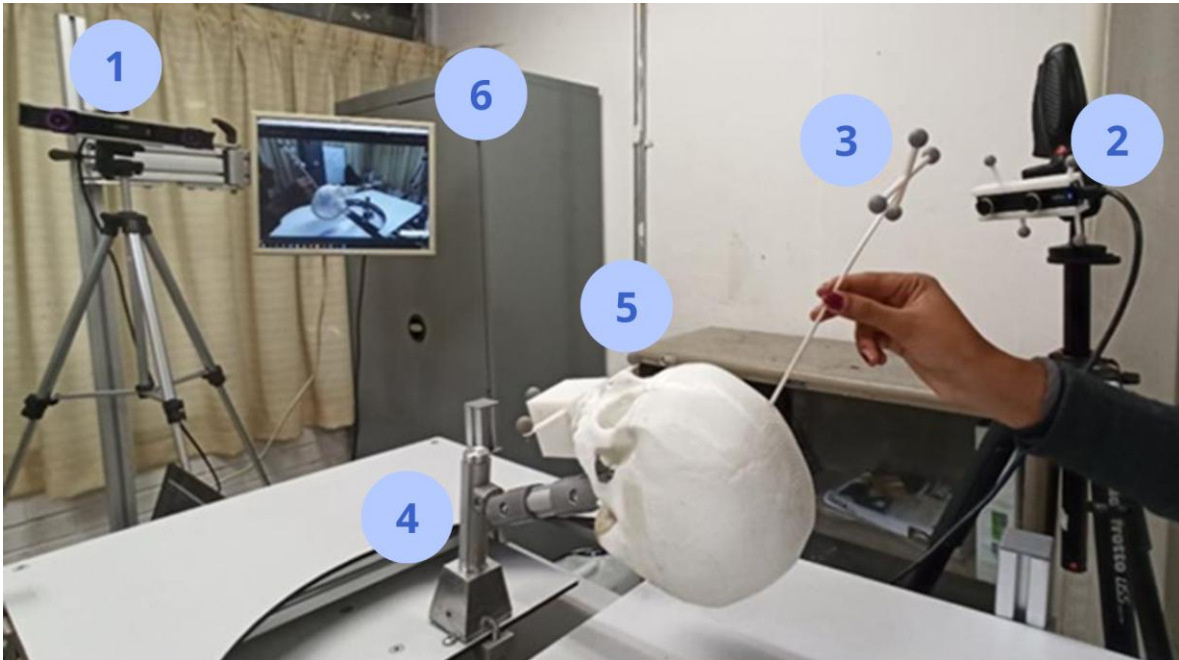
Figura 12. Instalación completa del simulador: 1) equipo de seguimiento óptico, 2) cámara estéreo, 3) herramienta de punción, 4) brazo de soporte, 5) cráneo impero en 3D y 6) monitor (modulo de trabajo). (Domínguez-Velasco et al., 2023)
