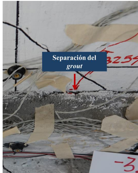
Figura 3.24 Separación del grout en la solera inferior de la cara Norte (ciclo 12, distorsión -3\% ).
