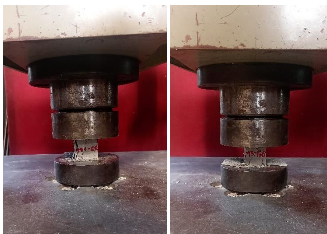
Figura 2.24 Pruebas de compresión en los cubos de grout.
