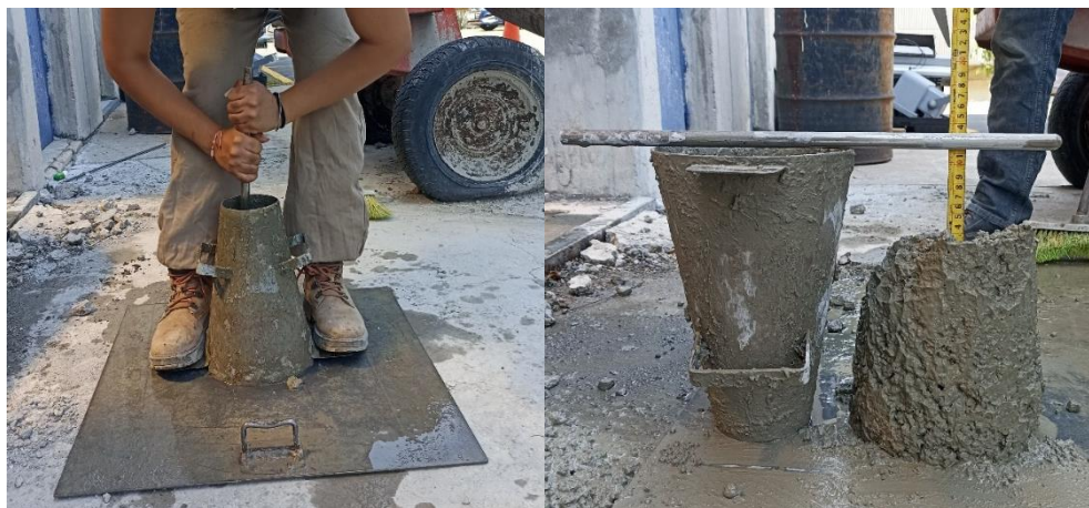
Figura 2.14 Realización de la prueba de revenimiento para el concreto que se utilizó para las columnas.
