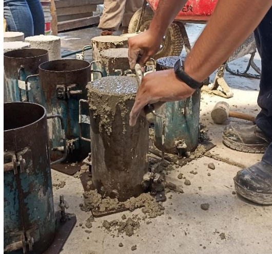
Figura 2.15 Nivelación de los cilindros de concreto.
