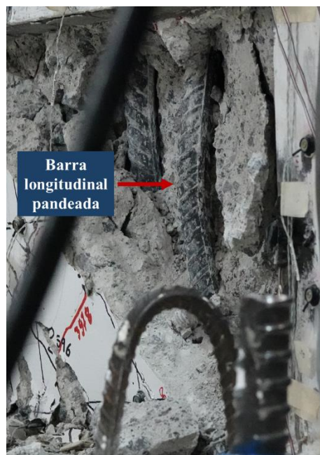
Figura 3.29 Barra longitudinal pandeada de la cara Norte (ciclo 18, distorsión ++4.5%).
