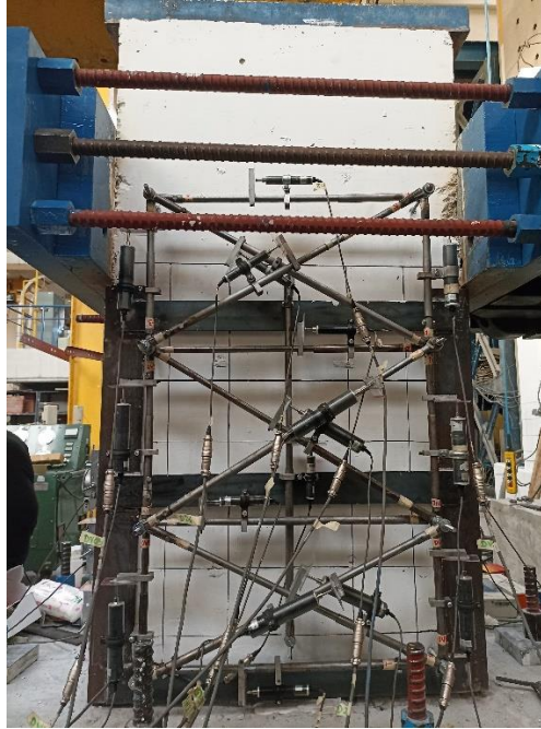
Figura 2.36 Transductores de desplazamiento colocados en el espécimen.
