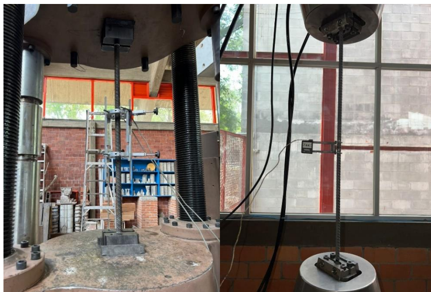
Figura 2.19 Pruebas de tensión de las barras de refuerzo.
