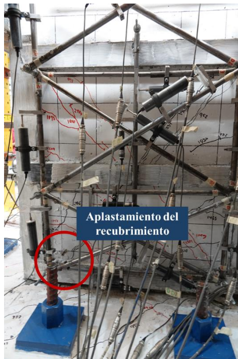
Figura 3.23 Aplastamiento del recubrimiento en la cara Sur (ciclo 12, distorsión ++3%).
