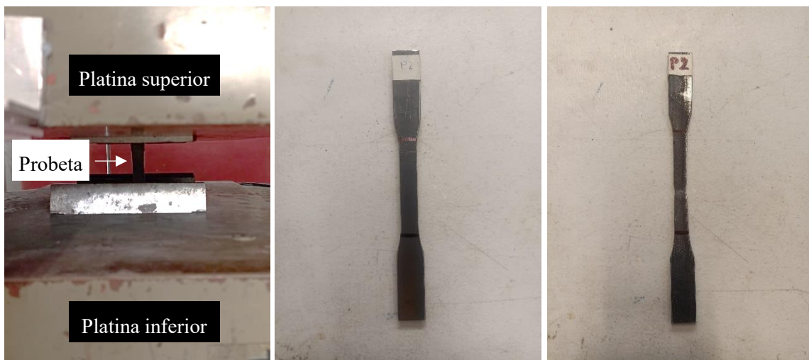
Figura 2.21 Prueba de tensión de una de las probetas de las soleras (al centro probeta antes de la prueba, a la derecha probeta después de la prueba).
