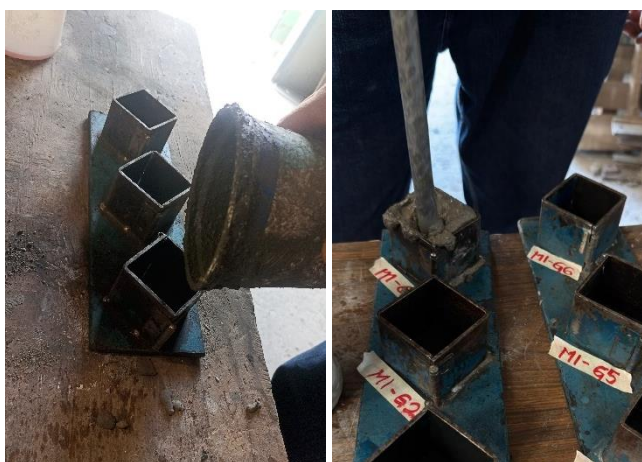
Figura 2.23 Realización de los cubos de grout.
