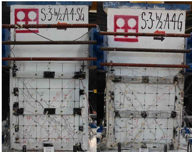
Figura 5.7 Agrietamiento de los especímenes a 2% de distorsión.
