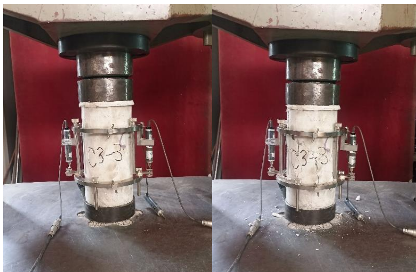
Figura 2.17 Prueba de compresión de los cilindros (a la izquierda cilindro antes de la prueba, a la derecha cilindro después de la prueba).
