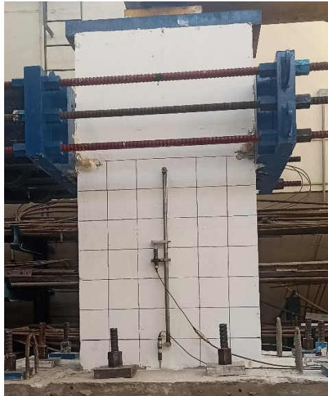
Figura 2.34 Transductores para medir el desplazamiento de la columna ante carga axial (cara Norte).
