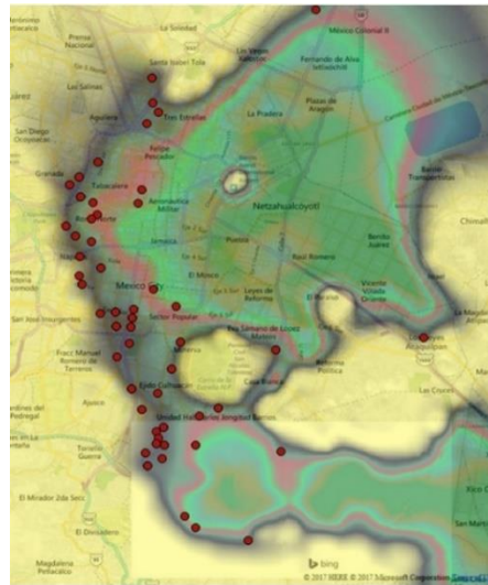
Figura 1.1 En los puntos rojos se localización los edificios colapsados o con graves daños debido al sismo del 19 de septiembre de 2017. La zona de transición se presenta en tonos grises. (Cruz et al., 2017)
