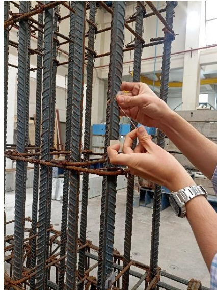
Figura 2.7 Colocación de un deformímetro eléctrico en la barra de acero.
