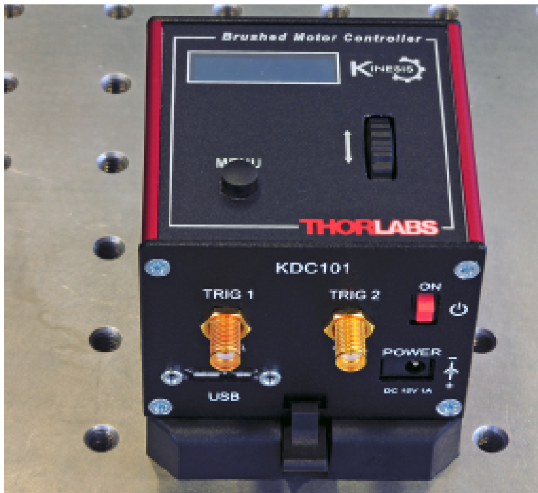
Figura 2.12: Fotografía del Driver para el control de los motores.
