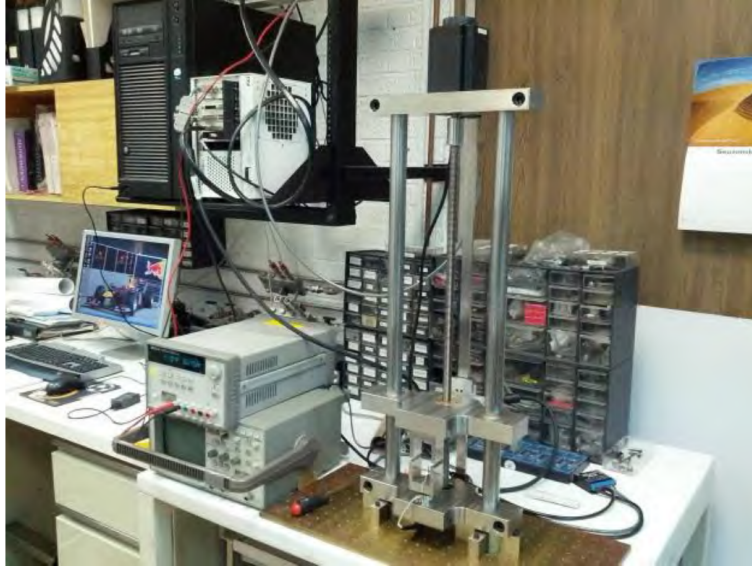
Figura 1.12: Foto del probador uniaxial. Imagen tomada de Tesis de Vázquez Flores 2014
