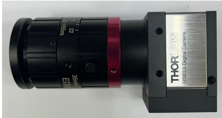
Figura 2.6: Fotografía de la cámara de Thorlabs con el lente.
