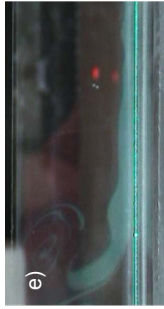
Figura 3.17 Desarrollo de los vórtices en un flujo con un alto nivel de turbulencia en la entrada, el flujo va de derecha a izquierda, a) formación del pico en la zona exterior, b) y c) desarrollo de un vórtice un la región interna y otro en la región externa, d) dipolo, e) el buen desarrollo del dipolo, ayuda a que el flujo penetre una buena distancia vertical.
