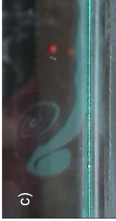
Figura 3.16. a) el sistema de vórtices no es alimentado suavemente, b) el conducto de fluido es estrecho y se rompe, entonces la ondulación que va a alimentar al sistema de vórtices se despega de la superficie y choca con la parte inferior del sistema de vórtices, c) se crea un vórtice con giro CW.
