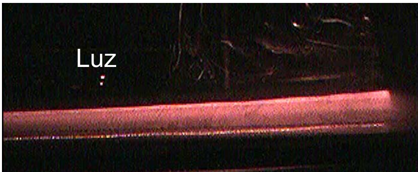
Figura 3.2. Flujo más estable, el régimen laminar ocupó toda la zona de estudio.
