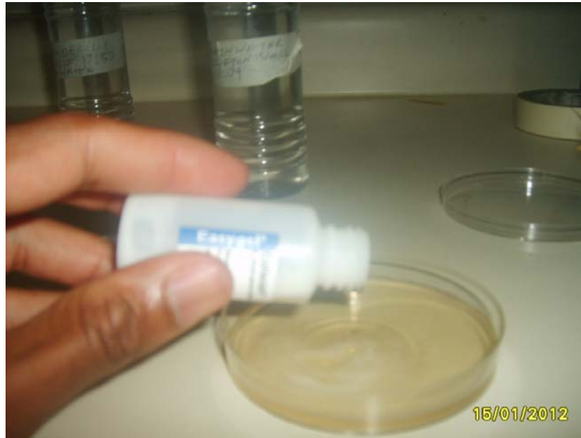
Figura 15 Vertiendo la mezcla de agua con medio coliscan a la caja petri
