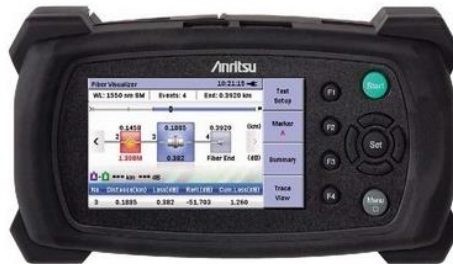
Figura 2.1. MT9090A μOTDR MODULE [16]
