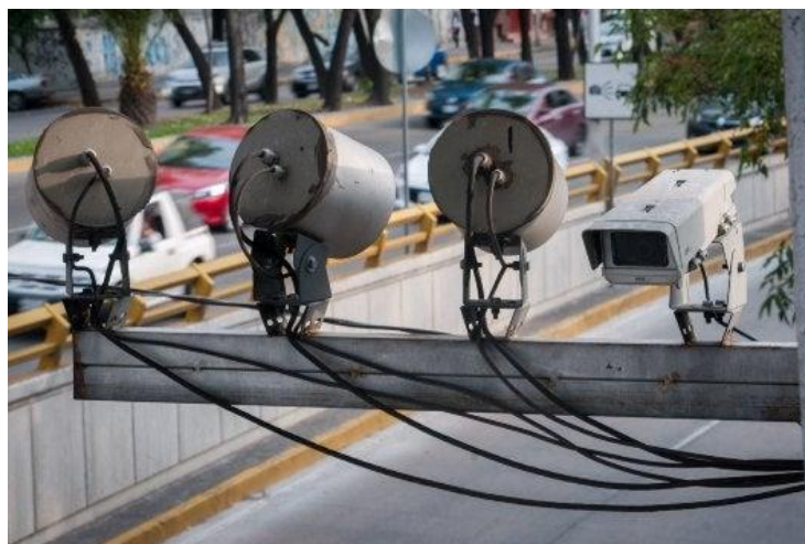
Figura 34 Sistema de cámaras y radares de las fotos cívicas y foto multas de la Ciudad de México
