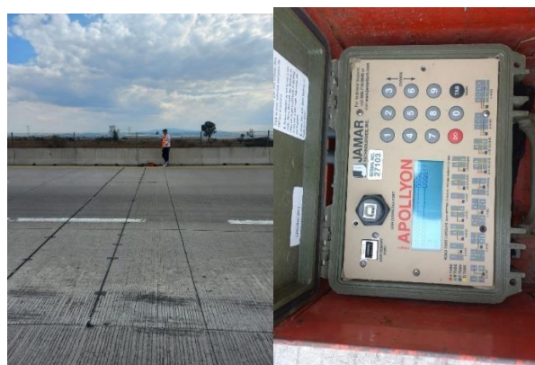
Figura 33 Manguera neumática y su dispositivo de conteo sobre el Macro libramiento de Querétaro
