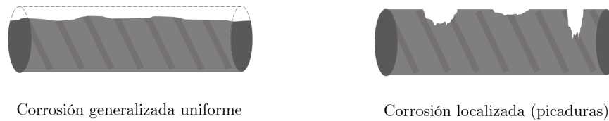
Figura 2. Principales configuraciones de corrosión en el acero de refuerzo
