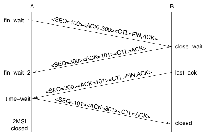
Figura 1.13: Cierre de conexión básico de 4 etapas de TCP
