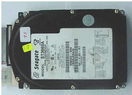
Figura 5.7 UDD para ensayo de simulación acelerada por corrosión, el cual fue protegido de los pines IDE y de alimentación.
