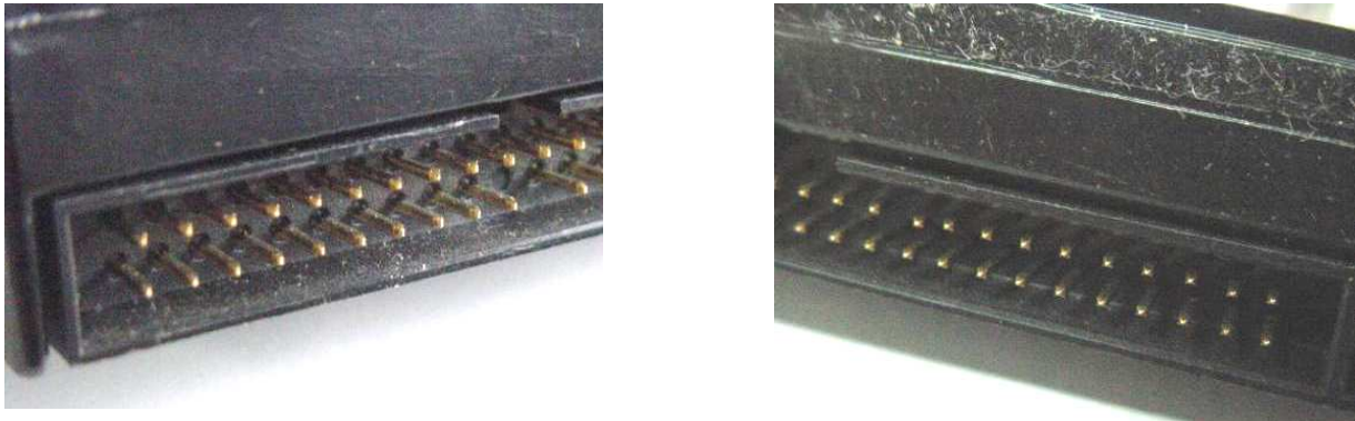
Figura 4.10 Pines IDE, se aprecia la acumulación de polvo, la cual afecta la conductividad de la corriente y el desgaste de dicha terminal.
