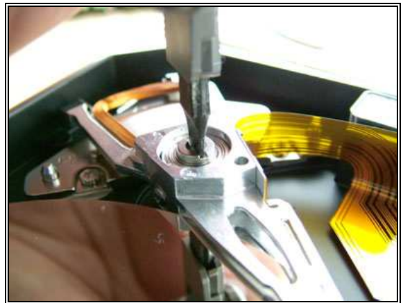
Figura 4.15 El retiro del plato y el del Brazo de debe de hacer con mucho cuidado sobre todo al desprender la C de L/E de dicho brazo para evitar la contaminación de partículas ajenas a la composición de estos y tener como resultado un análisis químico efectivo.
