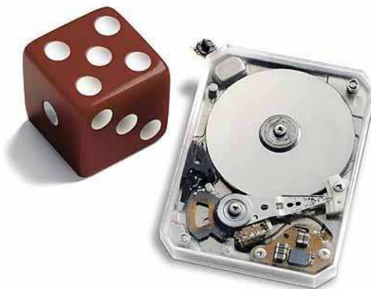
Figura 2.10 Disco Duro utilizado en sistemas de reproducción de audio - video móvil. [Toshiba Corporation 2005]
