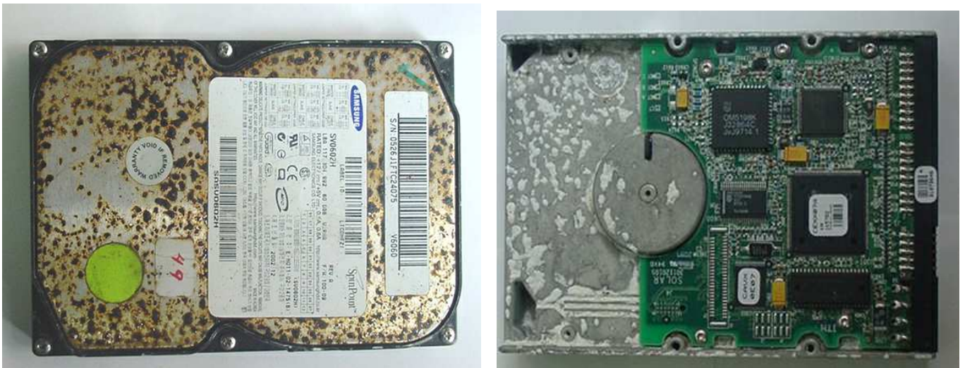
Figura 5.25 Apariencia de discos duros después de haber sido sometidos al ensayo de simulación acelerada por corrosión atmosférica donde se aprecia el óxido formado y la acumulación de condensado alrededor de la TC.
