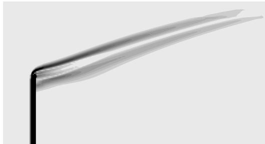
Figura 2.1: Visualización de una llama mediante su sombra
