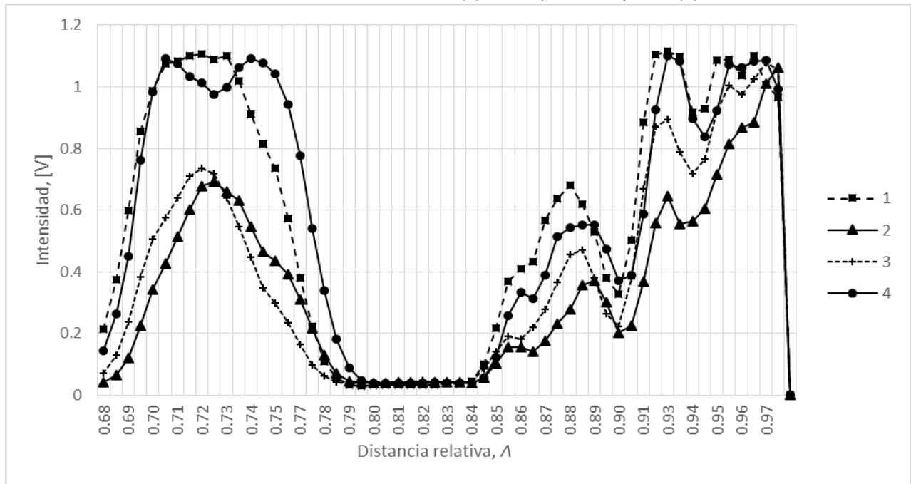
Figura 6.15. Distancia relativa vs Transmisión absoluta para diferentes posiciones del láser, elemento de detección semicilíndrico. ; (1) luz con polarización lineal vertical 90^\circ respecto a eje x; (2) luz con polarización lineal horizontal 0^\circ con respecto al eje x; (3) luz con polarización lineal a -45^\circ con respecto a eje x; (4) luz con polarización lineal a 45^\circ con respecto a eje x.
