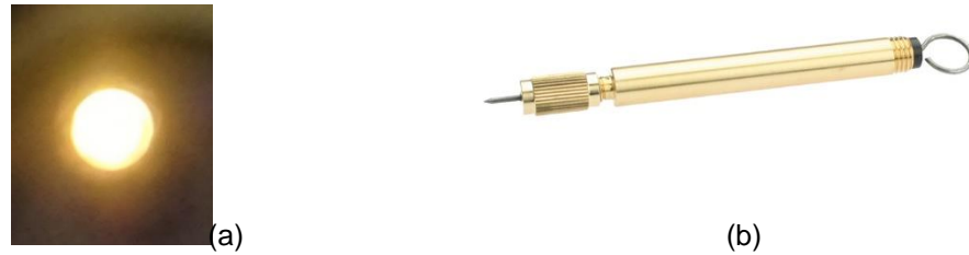
Figura 6.2. (a) Vista de la faceta de la fibra óptica, (b) Soporte de fibra utilizado en la instalación.
