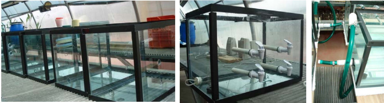
Figura 3.2 De izquierda a derecha: reactores vacíos, válvulas y tubos para muestreo en cara lateral; cuello de ganso para controlar el nivel del agua y punto de muestreo.
