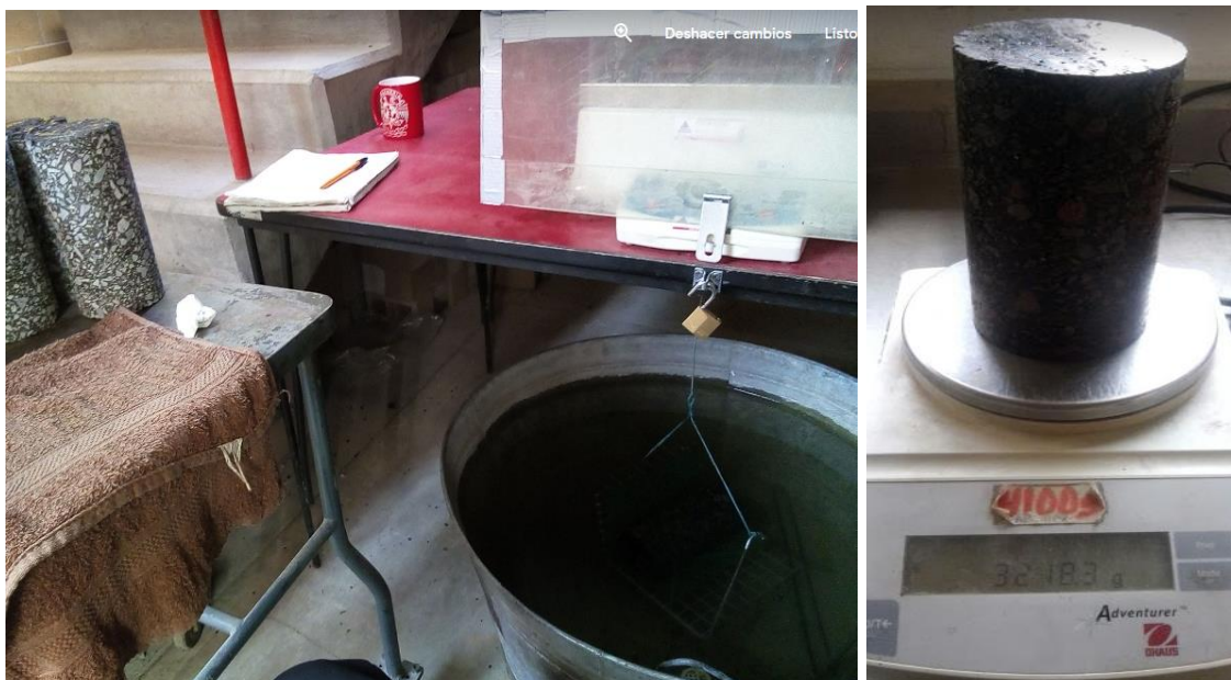
Figura 3.10.12 Procedimiento de prueba ASTM D3203 para obtención del contenido de vacíos de la mezcla compactada Elaboración propia
