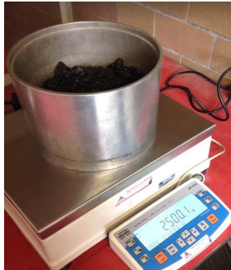
Figura 3.10.13 Muestra de mezcla asfáltica para obtención de la gravedad específica teórica máxima. Elaboración propia.
