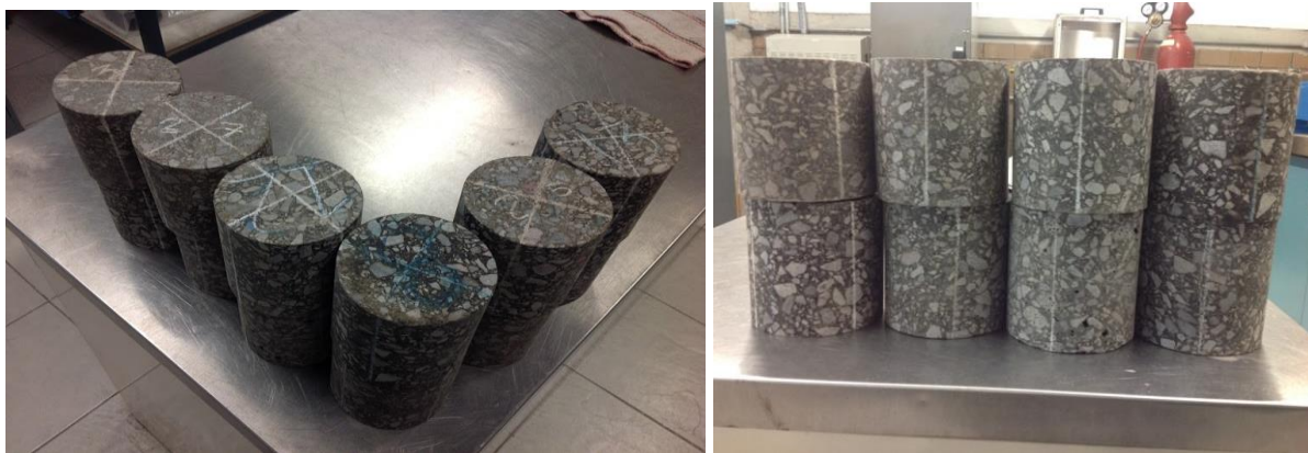
Figura 3.10.14 Probetas divididas en dos grupos (secas y humedo) para prueba ASTM D1075
