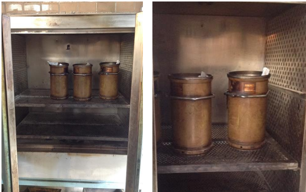
Figura 3.10.8 Mezcla asfáltica en moldes dentro del horno para llevar a temperatura de compactación Elaboración propia.
