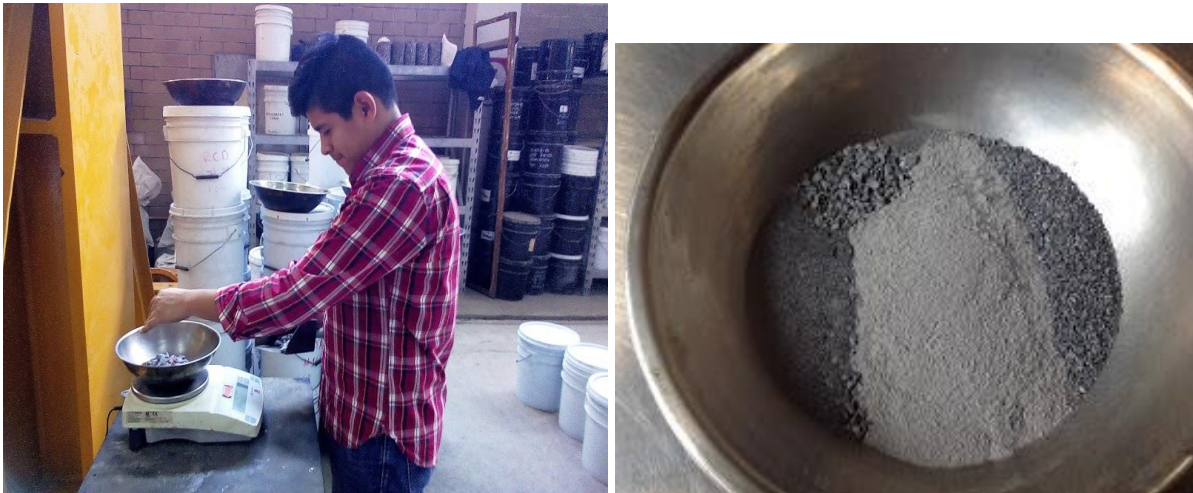
Figura 3.10.3 Dosificación del material para hacer cumplir con la granulometría propuesta. Elaboración propia.
