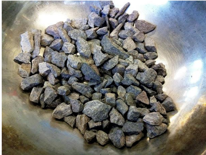
Figura 3.2.2 Partículas fracturadas con bordes afilados y superficies rugosas características del producto de trituración Elaboración propia.
