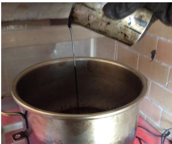
Figura 3.10.5 Dosificación de asfalto en mezcla asfáltica. Elaboración propia.
