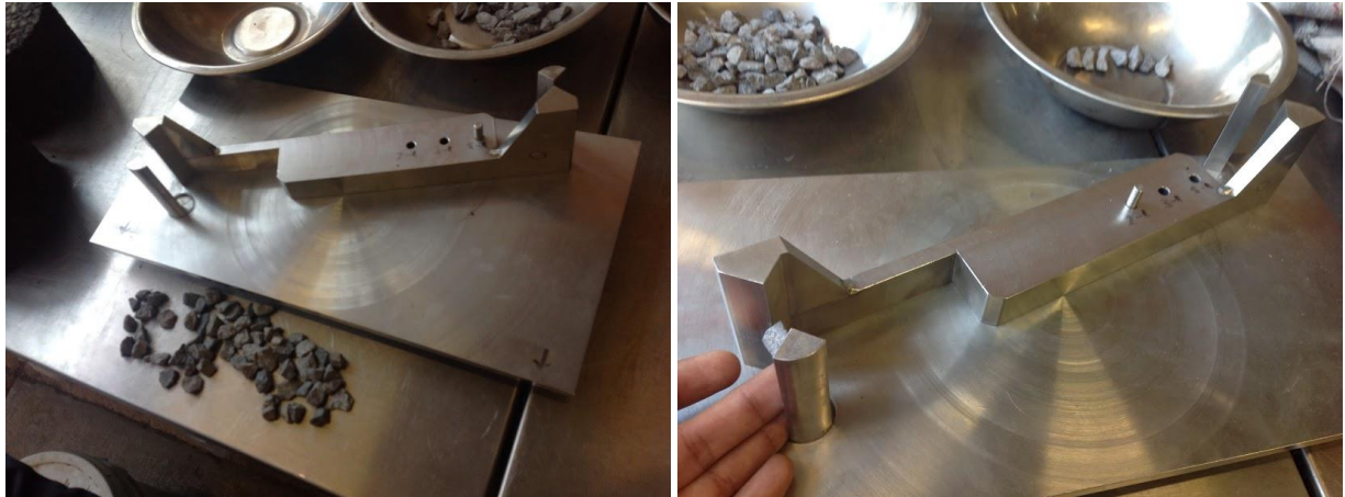
Figura 3.4.2. Calibrador proporcional de la Prueba ASTM D4791. Elaboración propia.
