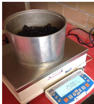
Figura 3.9.1 Muestra de mezcla asfáltica para obtención de la gravedad específica teórica máxima. Elaboración propia.
