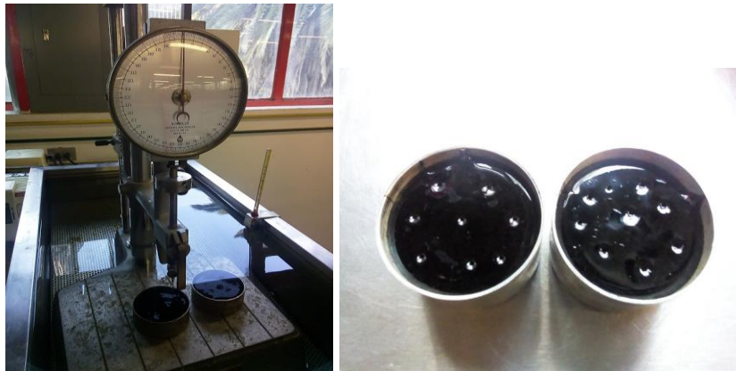
Figura 3.8.2. Prueba de penetración en el asfalto. Elaboración propia.
