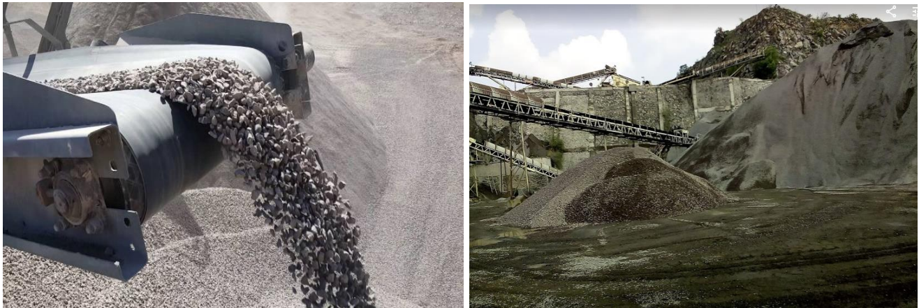
Figura 2.7.1 Agregados pétreos saliendo de una trituradora (Izq.) y vista general de la planta de asfalto Pinfra en Ixtapaluca. (Der.)
