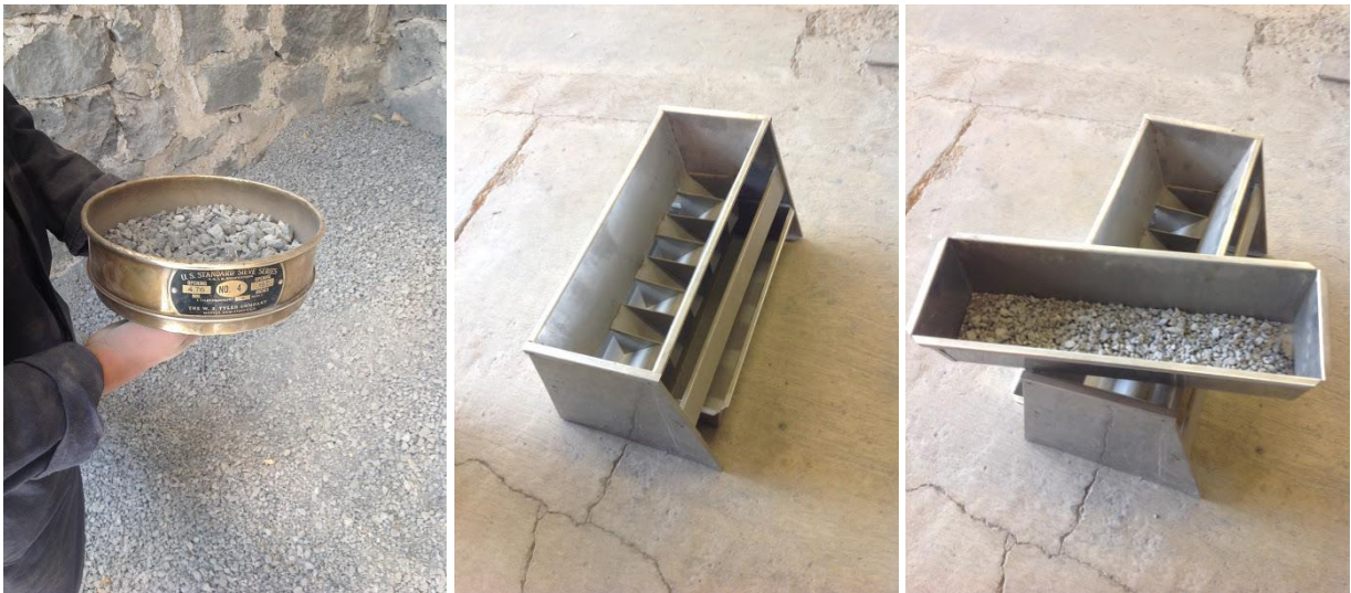
Figura 3.2.1 Separación del agregado grueso mediante tamizado y cuarteo de la muestra. Elaboración propia.
