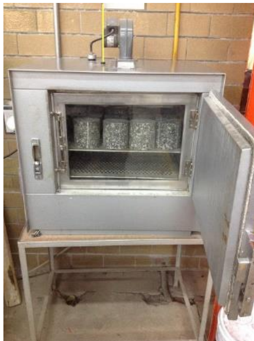
Figura 3.10.15. Acondicionamiento de probetas que se mantendrán secas a 25°C Elaboración propia.
