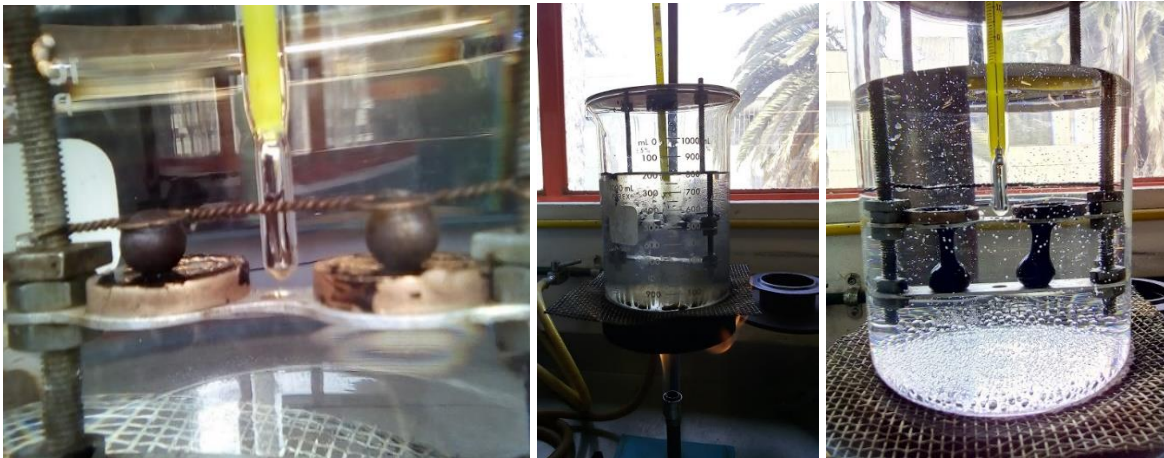
Figura 3.8.3. Prueba de reblandecimiento. Elaboración propia.
