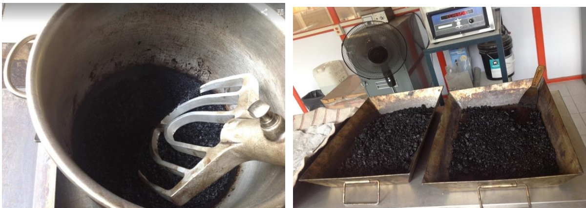
Figura 3.10.7 Mezcla en charolas para el proceso de envejecimiento a corto plazo. Elaboración propia.
