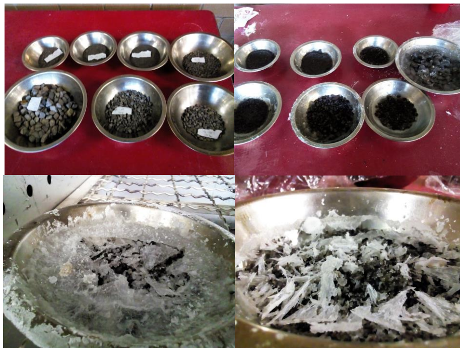
Figura 3.7.2 Ciclo de solvencia de agregados conocido como prueba de intemperismo acelerado. Elaboración propia.
