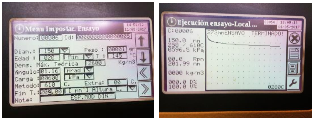
Figura 3.10.9 Programación de compactador giratorio Elaboración propia.
