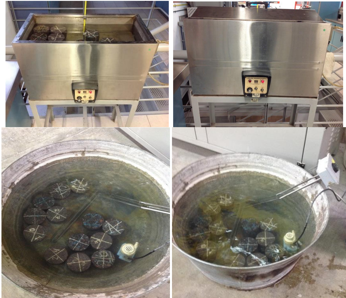
Figura 3.10.16 Acondicionamiento de probetas sumergidas en agua a 60°C (Fotos 1 y 2) y probetas sumergidas en agua a 25°C previo a la prueba de resistencia.
