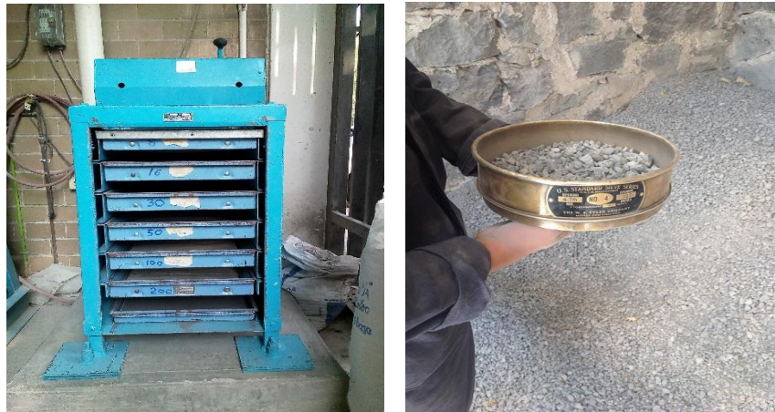
Figura 3.10.1 Cribadora mecánica y cribado por medios manuales con mallas estandarizadas Elaboración propia.
