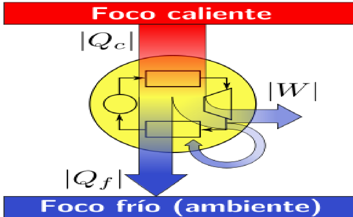
Figura 1.1 Segunda ley de la termodinámica a través de un equipo térmico
