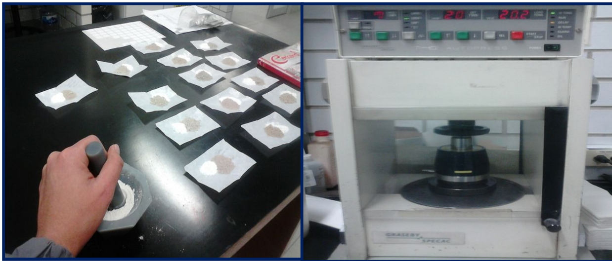
Figura 57, Proceso de molienda donde se observan el yoduro de Litio (blanco) y la muestra (izquierdo) Prensa hidráulica (derecha)
