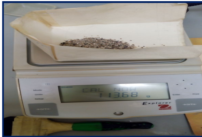
Figura 30, Medición del peso de las arenas
