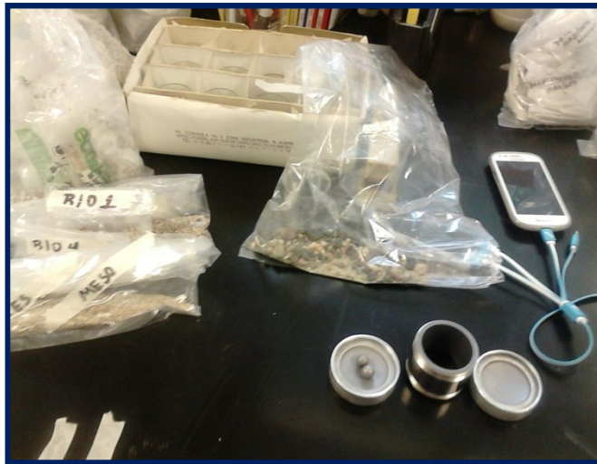
Figura 55, vial de tungsteno y un par de balines (antes de la preparación)
