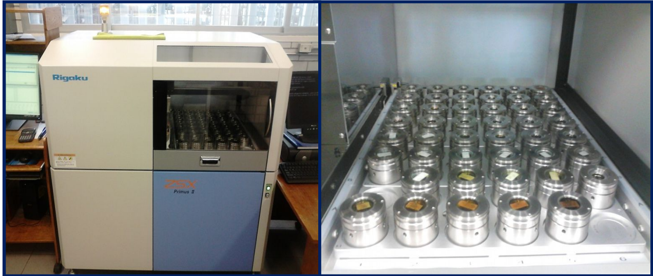
Figura 58, Espectrómetro de fluorescencia de rayos X (izquierda). Interior del espectrómetro donde se muestran las pastillas para su análisis (derecha).
