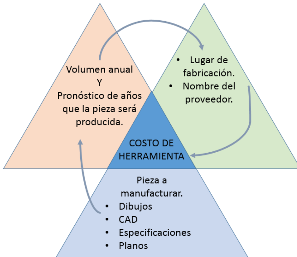
Imagen 2.1 Diagrama de proceso de costos para herramientas
