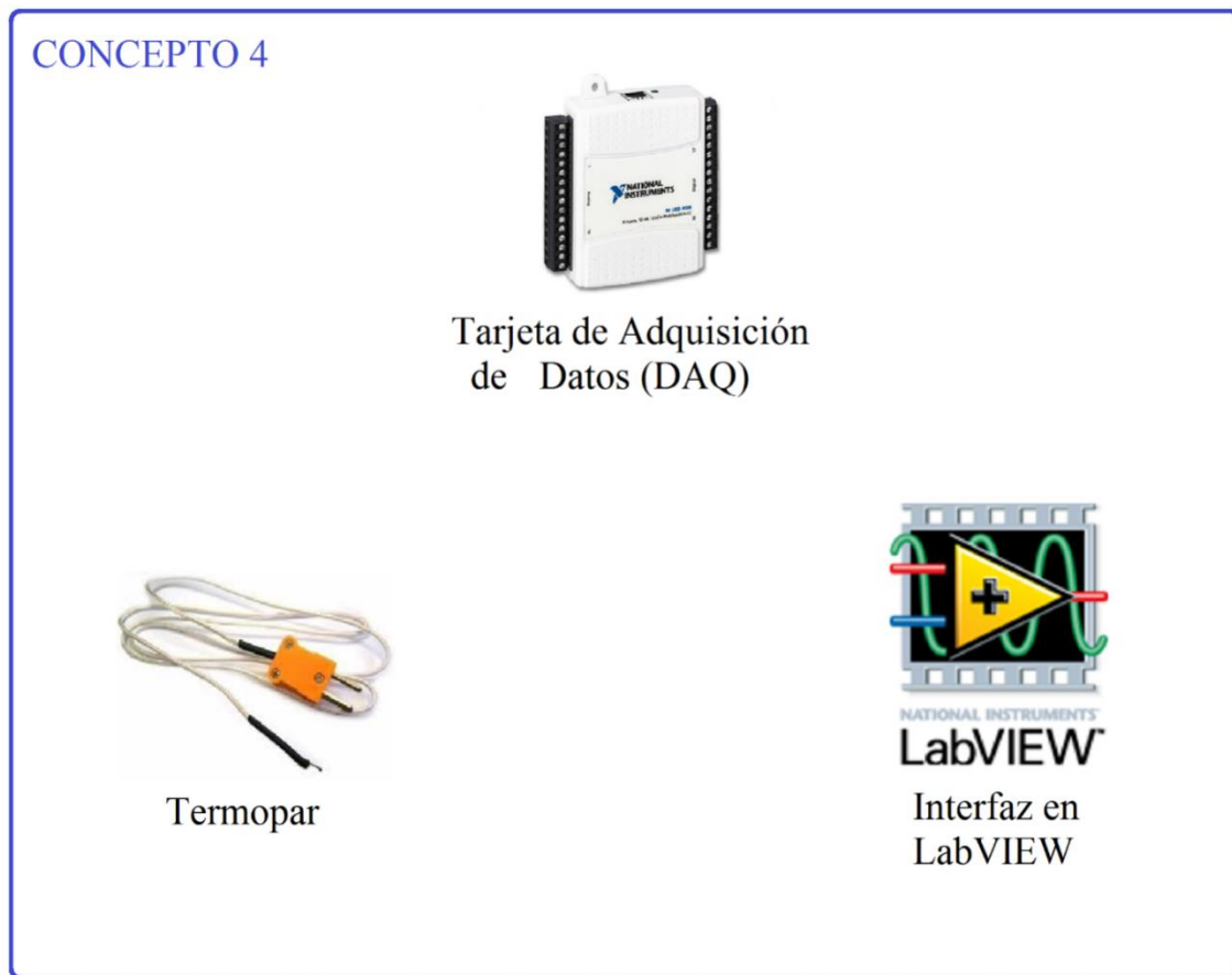
Figura 2.8. Termopar+ DAQ + LabVIEW
