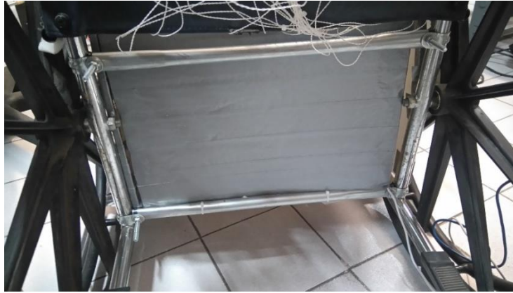
Figura 5.3. Panel de unicel forrado cuya función es aislar térmicamente el medio entre la cámara y la silla
