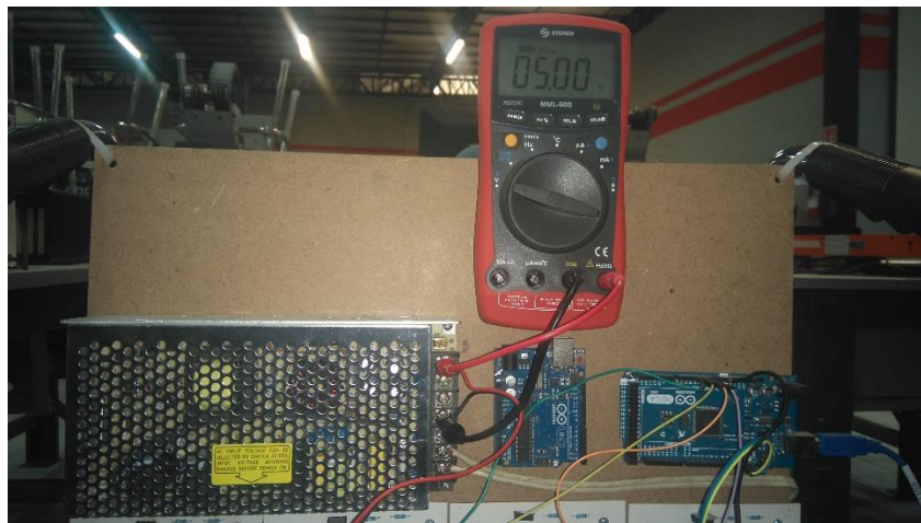
Figura 5.26. Calibración de la fuente de poder
