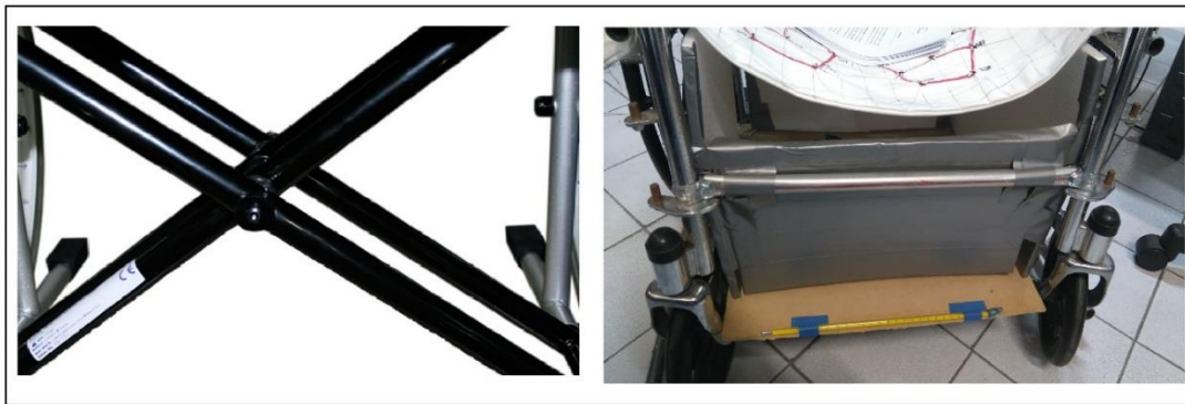
Figura 5.2. Cruceta de la silla de ruedas (izquierda), tubular de refuerzo puesto al quitar la cruceta (derecha)
