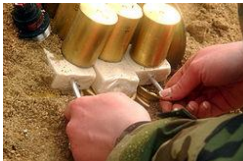
Imagen 8. Detonador eléctrico Dynadet
