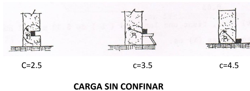
Figura 7. Radios de rotura
