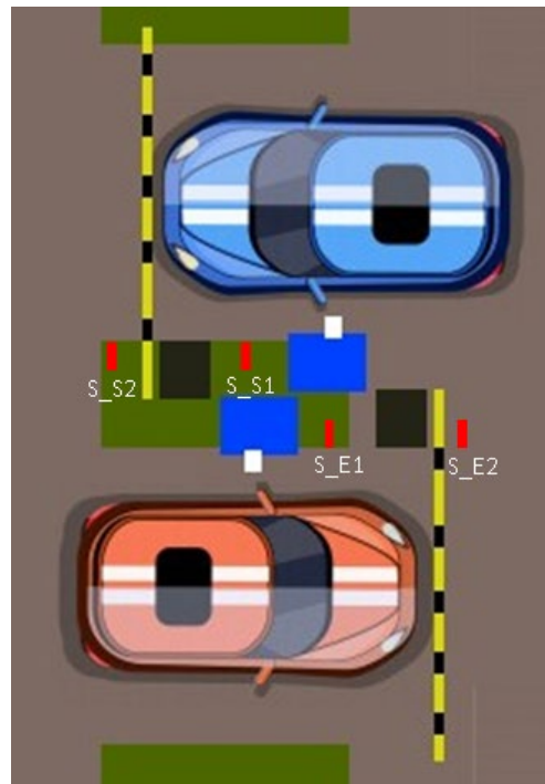
Figura P2.3 Sensores a la entrada y salida del estacionamiento.
