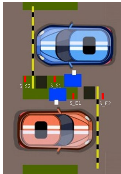
Figura P8.3 Sensores a la entrada y salida del estacionamiento.
