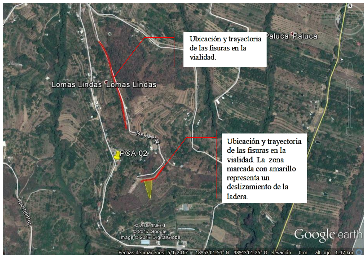
Foto No. 6.- Ubicación relativa de las grietas y un deslizamiento observado en el camino de acceso a Lomas Lindas.
