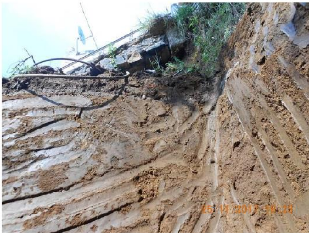
Foto No. 3.- Perfil estratigráfico del pozo a cielo abierto No. 2 (PCA-02). Tanto la estratigrafía como la consistencia son iguales a lo que se observó en el PCA-01
