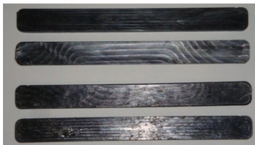
Figura 36. Probetas de flexión manufacturadas según norma ASTM D790.
