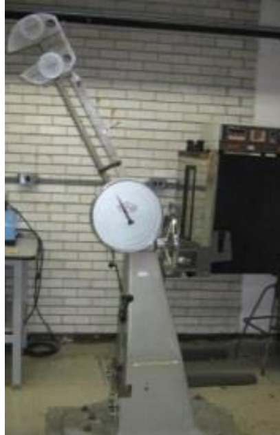
Figura 23. Máquina de pruebas de impacto. Instalaciones del laboratorio de pruebas mecánicas de la Facultad de Ingeniería de la UNAM.
