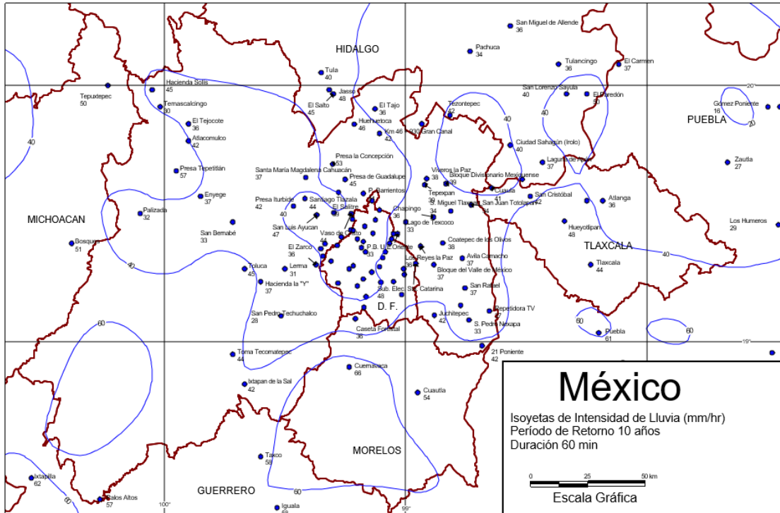
Figura 5.1 Mapa de Isoyetas de Intensidad de Lluvia (mm/hr), para un periodo de retorno de 10 años y una duración de 60 minutos (SCT).
