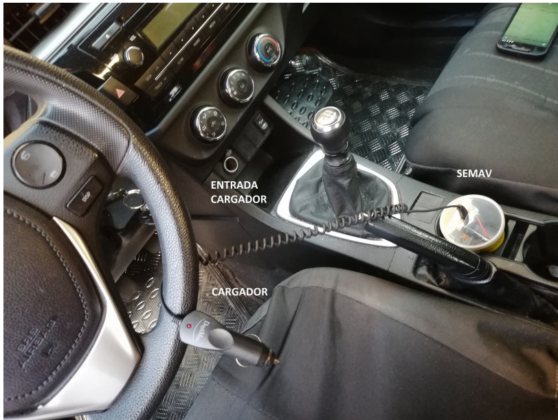
Figura 3.9: SEMAV colocado en el portavasos del automóvil y listo para conectarse al mismo.
