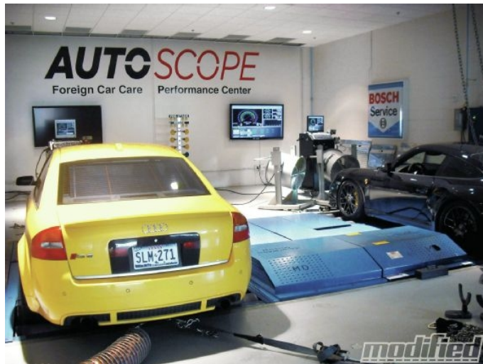
Figura 1.6: Fotografía de un arreglo experimental de un ensayo en dinamómetro de rodillos con apoyo visual para realizar un ciclo de manejo.
