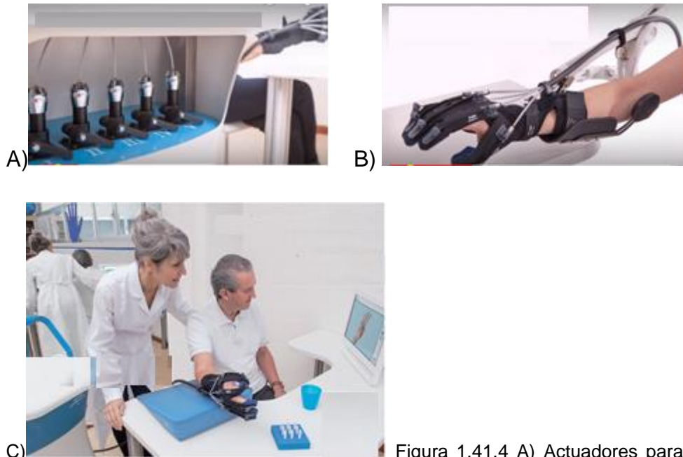
Figura 1.41.4 A) Actuadores para el control de los tendones artificiales. B) Chasis de soporte para brazo. C) Terapia asistida por pc touchscreen [9].
