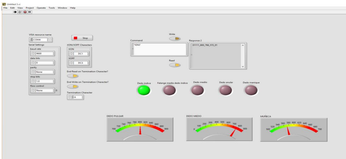
Figura 4.42. Se muestra la caratula del proyecto en LabView para la lectura del guante de datos.
