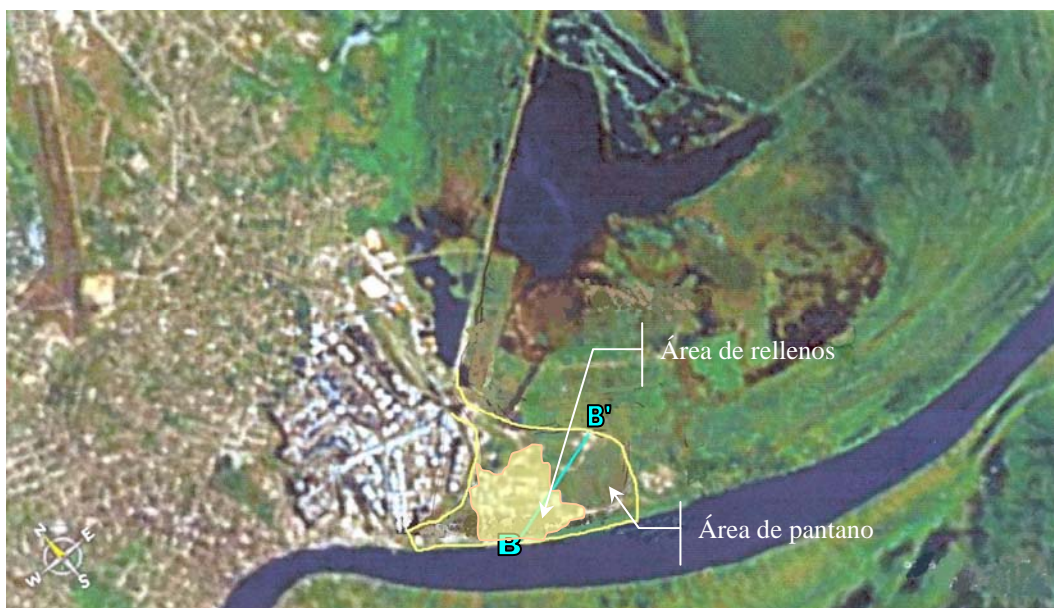
Figura No. 2.2.- Zonificación esquemática del predio (superficie de rellenos y de pantano). El eje de trazo B-B', representa la posición en planta del corte estratigráfico mostrado en la figura 2.3 .
