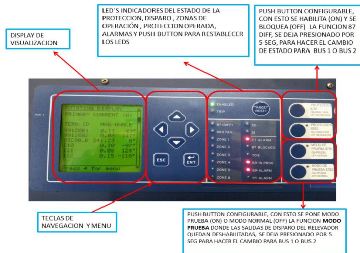
Figura 29. Características del panel frontal del relevador.
