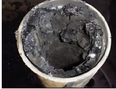
Figura 1.2 Vista de la sección transversal de una tubería con depósitos de asfaltenos (Goual, 2012).
