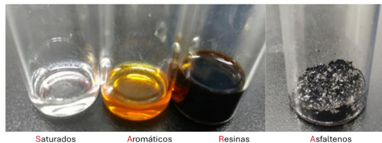
Figura 1.3 Ejemplo de la apariencia de las fracciones SARA obtenidas de un petróleo crudo (Park, 2022).
