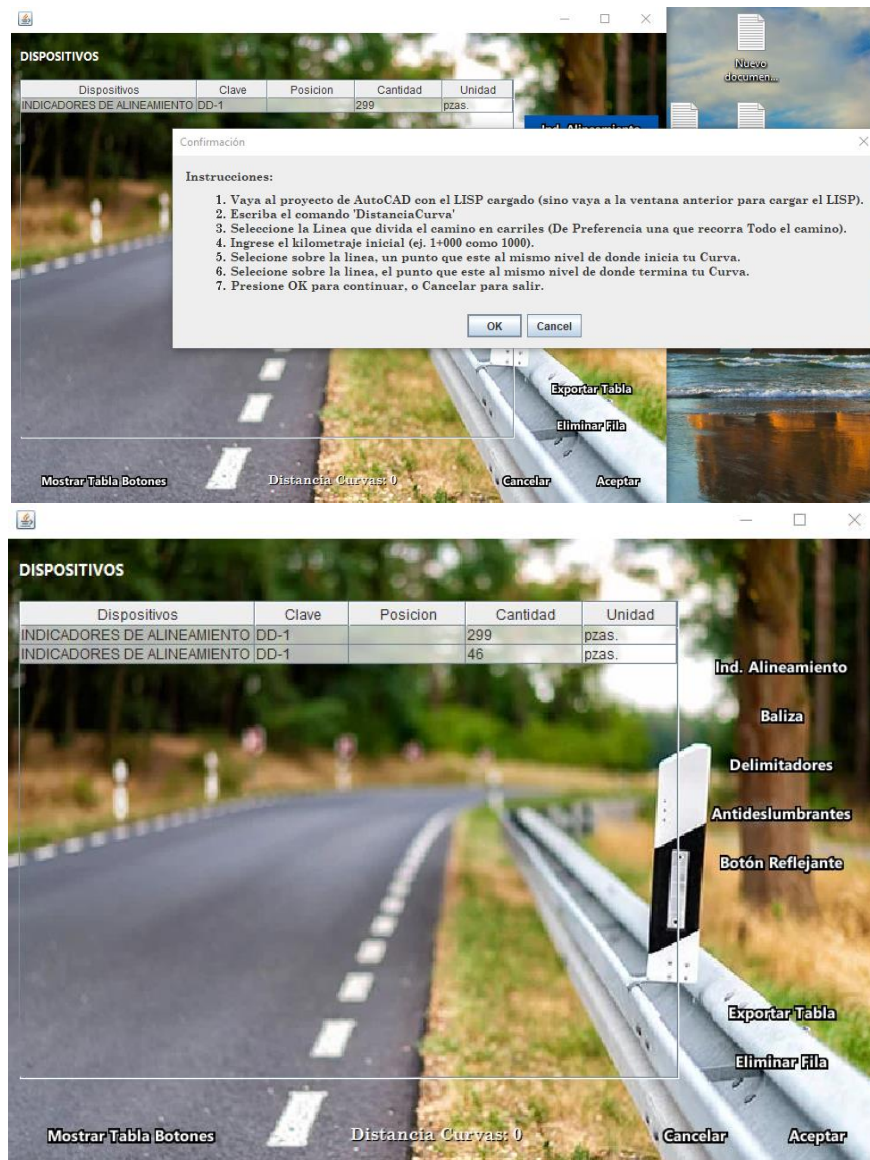
Figura 6.111. Aplicación: Agregando indicadores de alineamiento Curva
