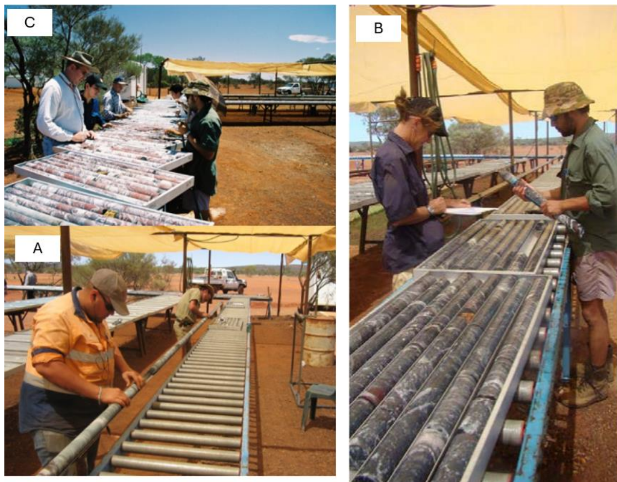
Figura 2. Manejo de testigos de roca (Castilla & Herrera, 2012).
