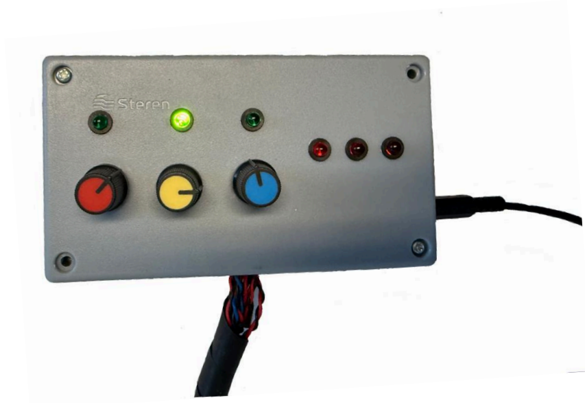
Figura 46. Gabinete de externo de control
