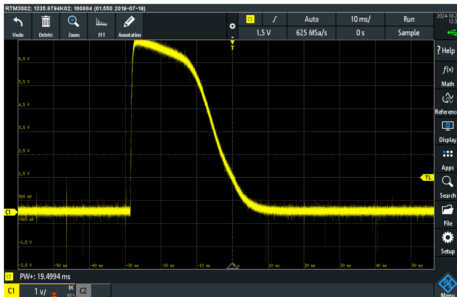
Figura 3.12: Duración del pulso del medidor de flujo de agua.
