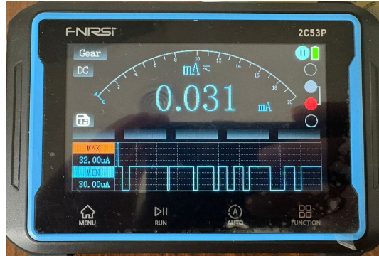
Figura 4.1: Medición de corriente del CubeCell en modo sleep.
