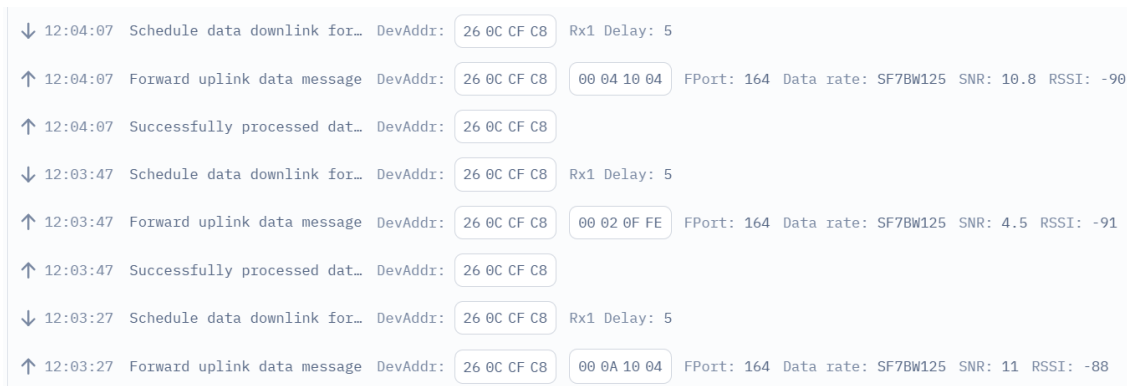
Figura 5.3: Mensajes del nodo terminal con el medidor de flujo de agua.
