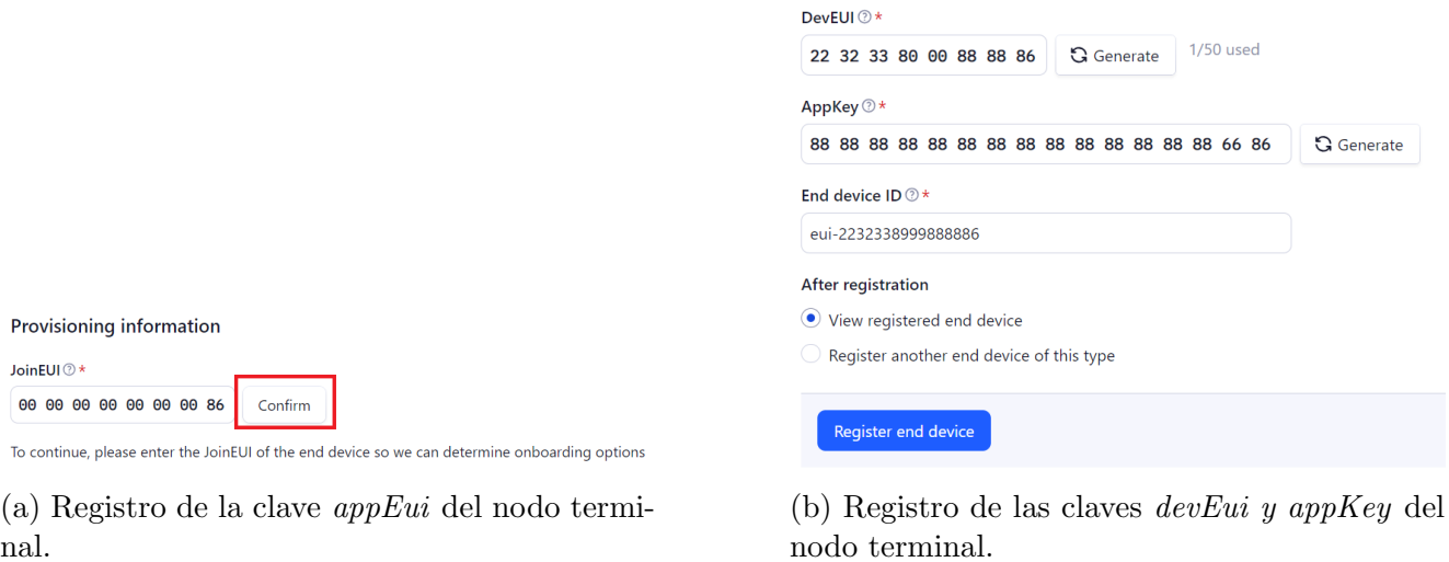
Figura 3.18: Registro final del nodo terminal en The Things Network.
