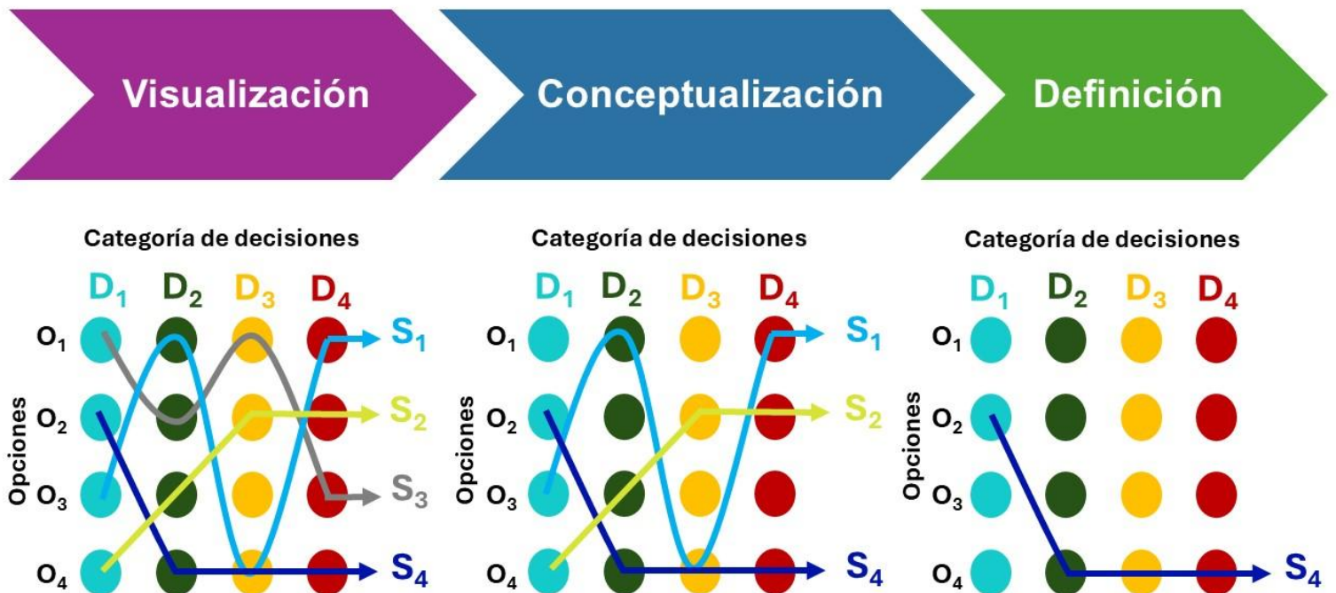
Figura 3.11. Optimización del Escenario de Decisión (DSO) en distintas fases del proyecto (Front-End-Loading (FEL) Process Supporting Optimum Field Development Decision Making, 2013)
