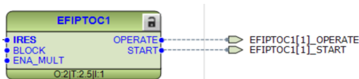
Imagen 253_Bloque EFIPTOC1 con ambos puertos de salida conectados a nuevas variables.
