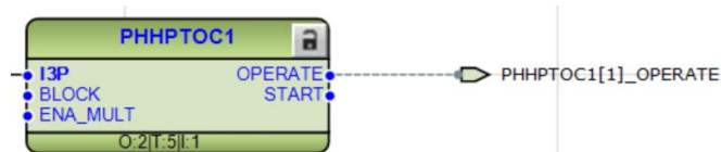
Imagen 224_Conexión de la salida PHHPTOC1[1]_OPERATE al puerto OPERATE.
