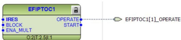
Imagen 251_Conexión de la variable EFIPTOC1[1]_OPERATE al puerto de salida OPERATE del bloque EFIPTOC1.
