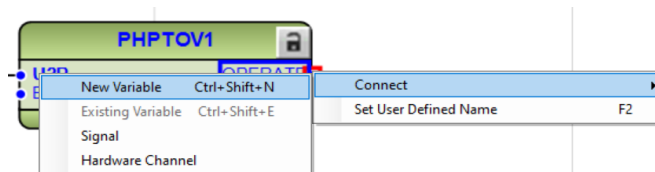
Imagen 258_ Conexión de una nueva para el puerto de salida OPERATE del bloque PHPTOV1.
