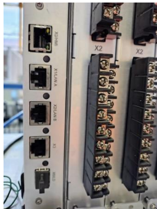
Imagen 1_ Puertos de conexión del módulo de hardware del relé REX640.
