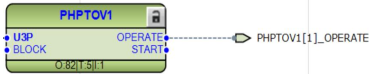
Imagen 259_ Variable PHPTOV1[1]_OPERATE conectada al puerto de salida OPERATE del bloque PHPTOV1.
