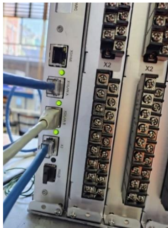
Imagen 4_ Puertos en uso del módulo de hardware del relé REX640.
