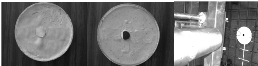
11. Las imágenes a) y b) muestran las probetas metálicas con acabados de 2.3\mu\text{m} (a) y 0.4\mu\text{m} (b). La imagen c) muestra la disposición de la probeta para ser proyectada térmicamente.
