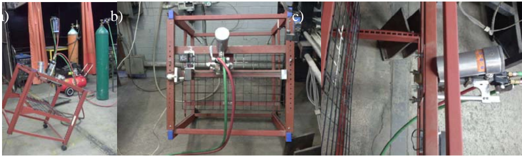
Figura 16. Posición de la pistola de proyección térmica a) tradicional, posición utilizada en este proyecto b y c).
