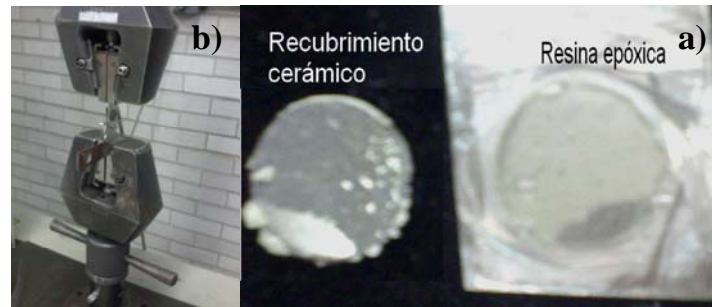
Figura 26. Imágenes de la prueba de adherencia de las probetas recubiertas de HA sobre Ti6Al4V a), imagen a 8x de las superficies de la probeta cilíndrica recubierta y de la placa con resina epóxica después de ser sometidas a la prueba de adherencia b).
