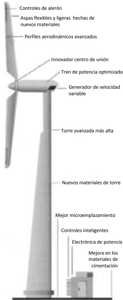
Figura 2. 2 Turbina eólica moderna para generación de energía a gran escala [6]
