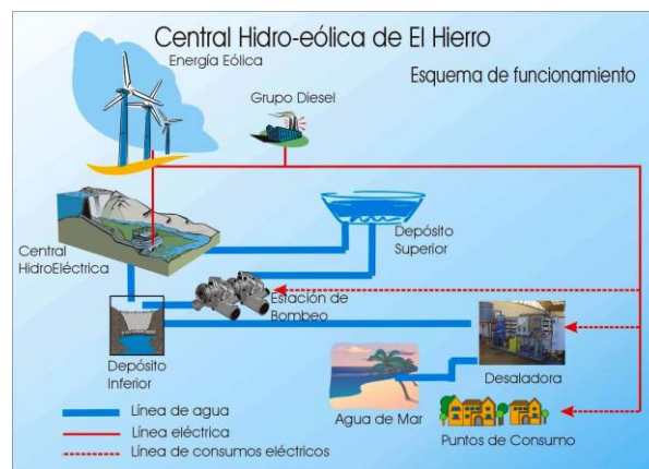
Figura A. 7 Esquema de central hidroeléctrica [15]
