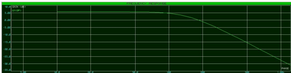
Gráfica 20 Análisis en frecuencia del circuito integrado con frecuencia de corte en 150 \text{ Hz} Proteus fuente: autor.
