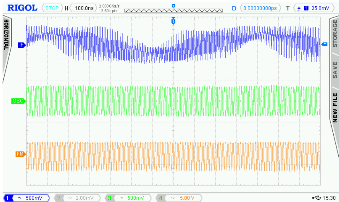
Figura 5.16 Mezclador, IF) Frecuencia intermedia, OSC) Oscilador local de 84.8 MHz, FM) Señal de frecuencia modulada.
