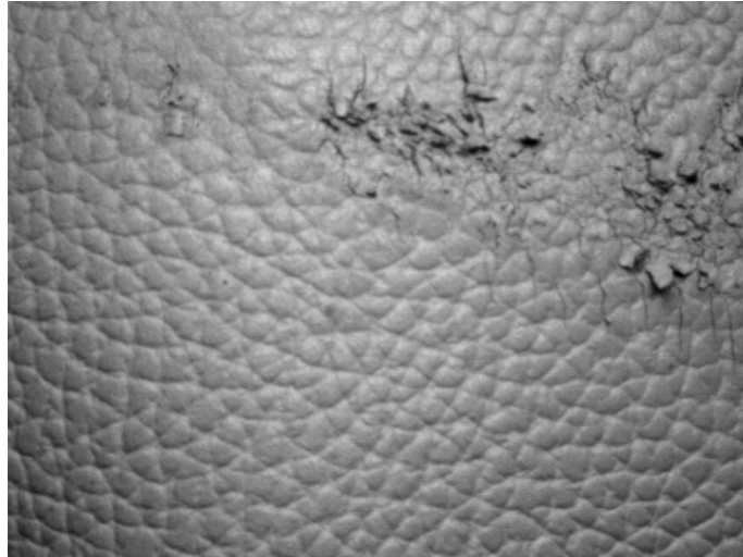
Figura 5.8: Tercera muestra con defecto para el entrenamiento del NI training texture .
