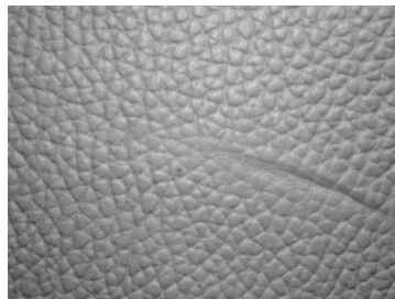
Figura 5.35: Defecto proveniente de la piel curtida No5 que no fue detectado por el algoritmo.
