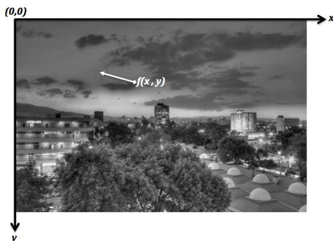
Figura 1.1: Convención de ejes utilizado para la representación digital de imágenes. *Elaboración propia (Julio-2012)
