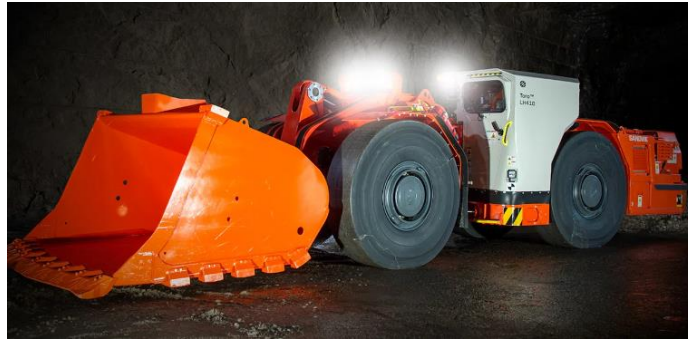
Figura 31. Scooptram LH410 de la marca Sandvik. (Sandvik, Cargadores, 2024)
