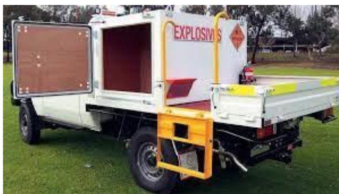
Figura 35. Camión transportador de explosivo interior mina. (MAELF, 2024)
