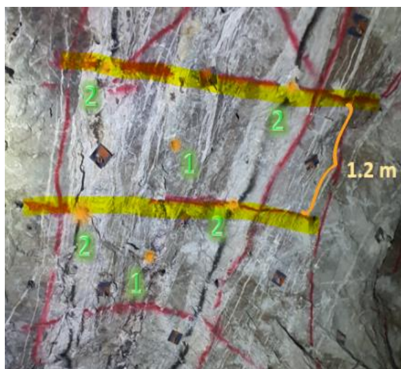
Figura 44. Vista superior de barrenación en veta con potencia mayor a 70 cm.
