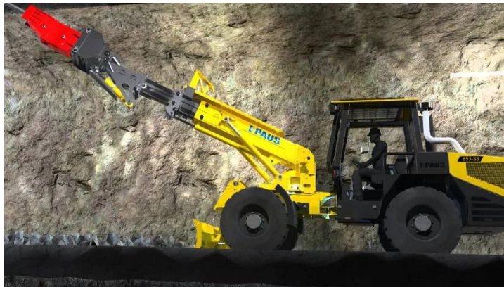
Figura 30. Vista lateral de equipo Paus. (Minera, 2018)
