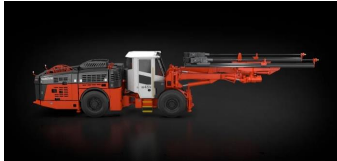
Figura 28. Jumbo electrohidráulico de un brazo. (Sandvik, Ficha técnica DD422iE Sandvik, s.f.)
