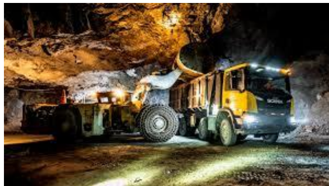
Figura 32. Scooptram cargando un camión de bajo perfil
