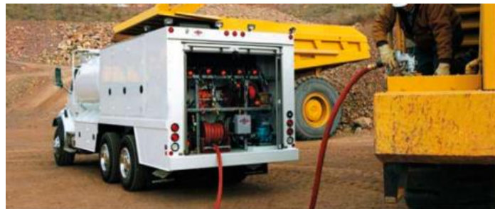
Figura 34. Orquesta de lubricación con camiones yucle (SERRETECNO, 2013)
