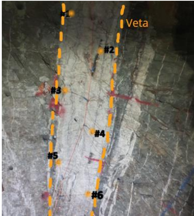
Figura 16. Vista superior de numeración de retardos MS para corte de veta
