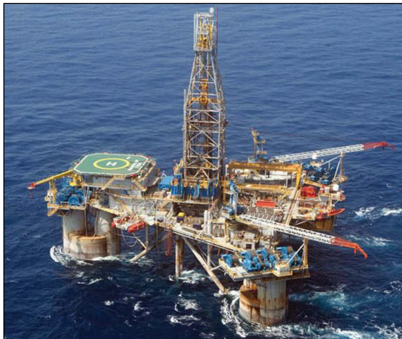
Fig. 2.4.2.2.1 Sistema de Perforación Semisumergible. Tomado de: IADC. Types of Drilling Rigs (RT) . 2015
