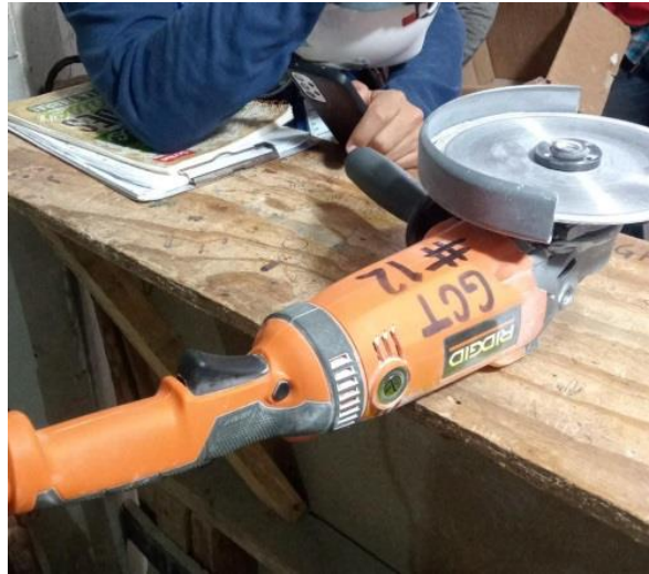
Esmeril para realizar cortes de block con disco de corte para concreto.
