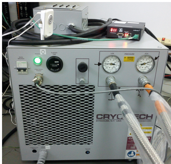
Figura 4.20: Criocompresor CRYOMECH (modelo CP830) utilizado para enfriar los detectores dentro del dewar. Sobre el compresor se encuentran también una cámara TPLink (al frente) y relevador de potencia (detrás), a un lado está colodo un amperímetro
