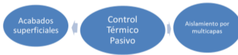
Figura 25. Tipos de control térmico pasivo.
