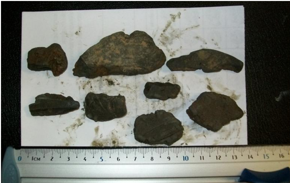
Figura 6.10.- Derrumbe del pozo H-101.
