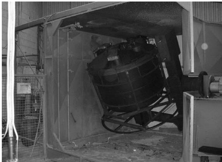
Figura 2.3.F Muestra el enfriamiento de un molde en la cámara de enfriamiento. [2]
