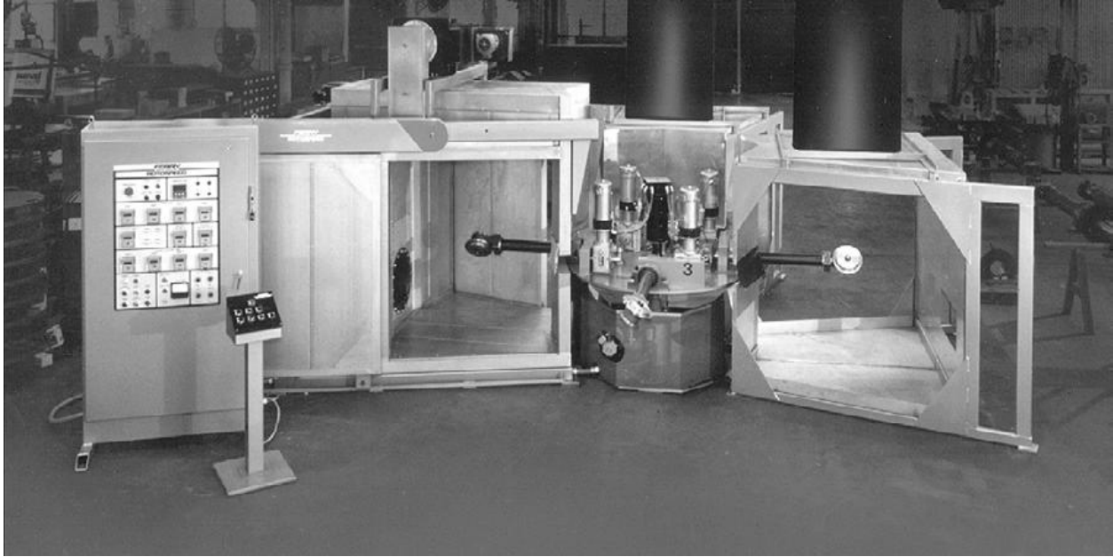
Figura 2.3.B Máquina de rotomoldeo tipo torreta de brazo fijo, ésta máquina es de horno cerrado se observa el compartimento al lado izquierdo donde se realiza el calentamiento.
