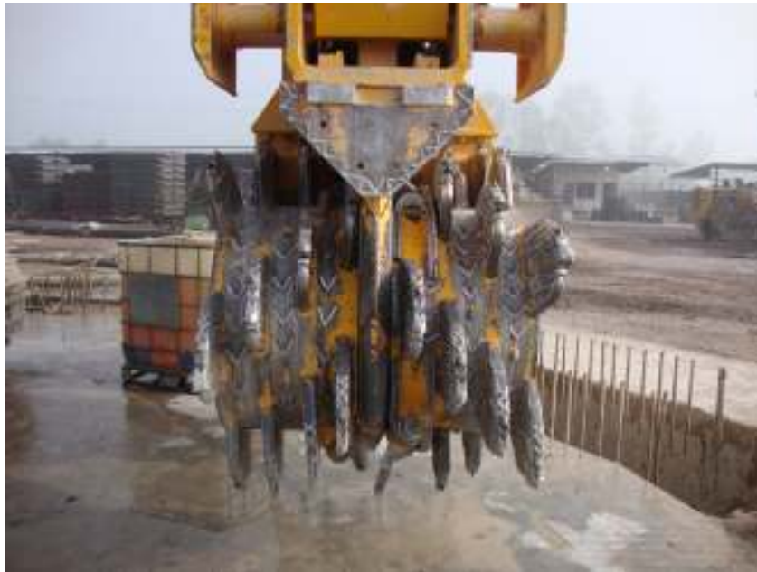
Vista lateral de las ruedas de corte y disposición de los dientes de corte.
