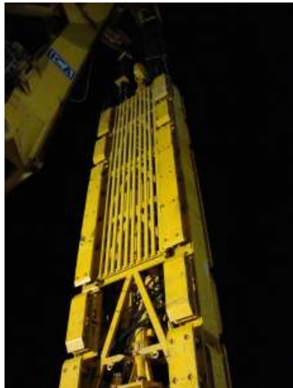
Gatos hidráulicos en cabezal de corte.
