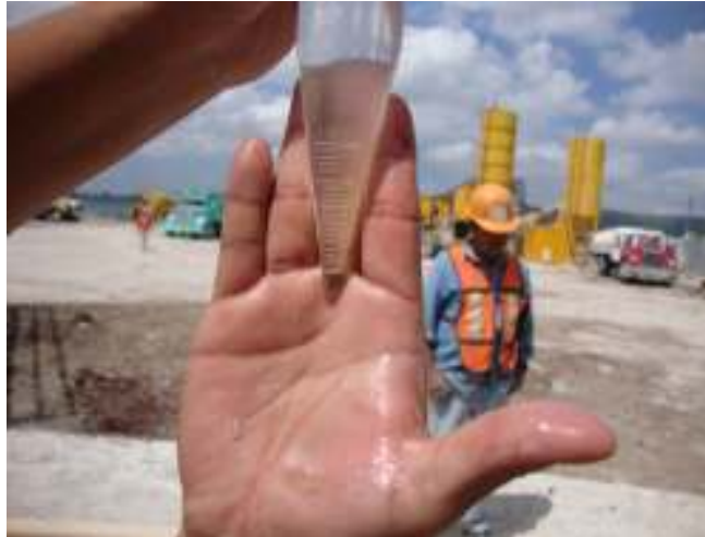
Prueba de contenido de arenas del lodo bentonítico
